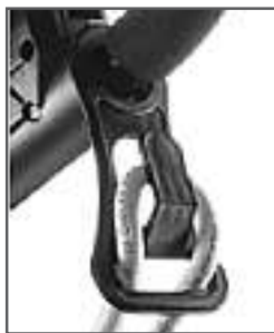
Рис. 10 Фиксация кабеля удлинителя на рабочей рукоятке
