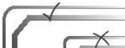
Рисунок 8 – Все изгибы должны иметь плавный переход
