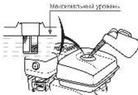
Рис. 16 Максимальный уровень топлива в топливном баке
