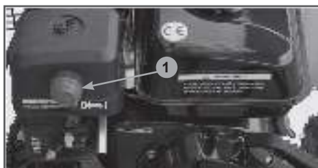
Рис. 22 Расположение ручного топливного насоса
