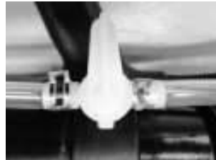
Рис. 8 Установка выпускного шланга на штуцер запорного крана
