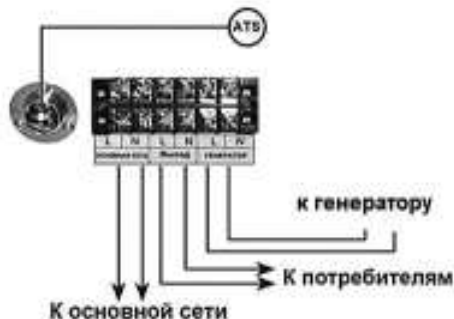
Рис. 15 Схема подключения блока ATS
