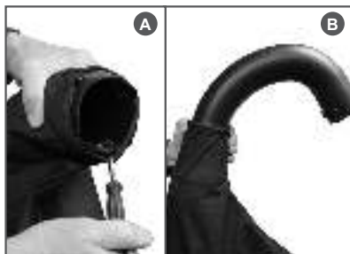
Рис. 6 Установка мешка на разгрузочную трубу
