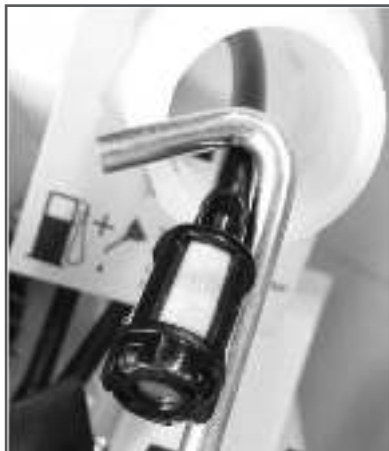
Рис.13 Обслуживание топливного фильтра
