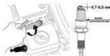
Рис. 24 Обслуживание свечи зажигания
