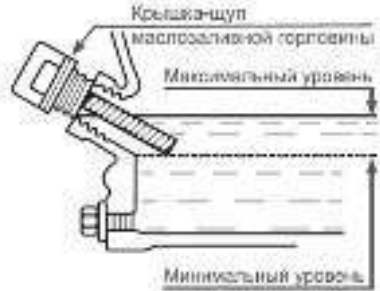
Рис. 12 Проверка уровня масла в картере
