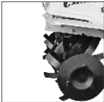
Рис. 18 Кронштейн с транспортировочным колесом снят
