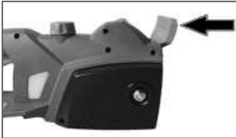
Рис. 2 Отключение тормоза цепи
