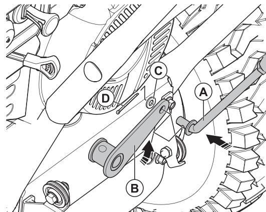
Установите на снегоуборочной машине в отверстие коннектора (B) тягу (A) и закрепите, используйте крепежные элементы - №12: (C) шайба - 1 шт.; (D) шплинт - 1 шт.
