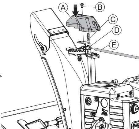
Проденьте рукоятку поворота желоба (A) через хомут (B) нижней рукоятки и установите её в отверстие рулевого механизма, зафиксируйте штифтом. Установите декоративную крышку (A) и зафиксируйте ее. Используйте крепеж из бокса №10: (B) болт M6×12 – 1 шт.; (C) шплинт – 1 шт.; (D) гроверная шайба D8 – 4 шт.; (E) Гайка M8 – 4 шт.
