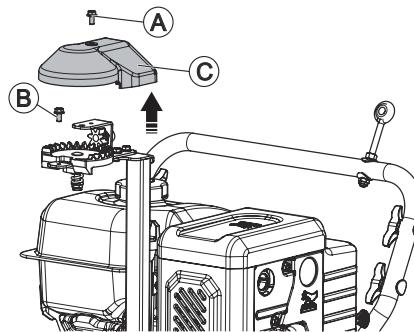
Снимите верхнюю крышку, установите и закрепите поворотный желоб используя крепеж из бокса №8: (A) болт M8x16 – 1 шт.
