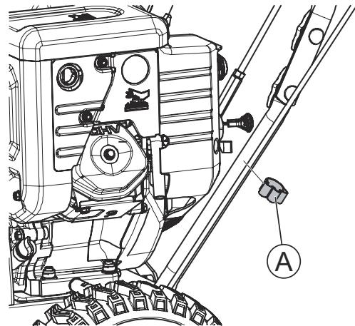
Совместите отверстия нижней и верхней рукояток, и закрепите при помощи болтов и пластиковых барашковых гаек. Используйте крепёжные элементы - бокс №3: (А) болт M8x50 – 4шт.; (В) фигурная шайба – 4 шт.; (С) барашковая гайка M8 - 3 шт. Затяните болты от руки. Закрепите трос привода шнеков.
