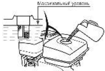
Рис. 5 Максимальный уровень топлива в топливном баке
