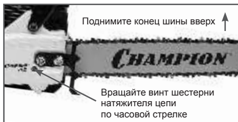
Рис. 5 Регулировка натяжения цепи
