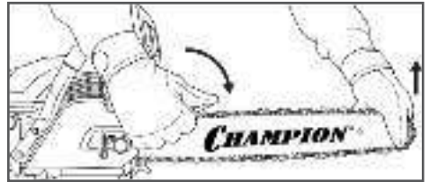
Рис. 4 Затяжка гаек крепления крышки шины
