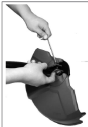
Рис. 3 Установка защитного кожуха
