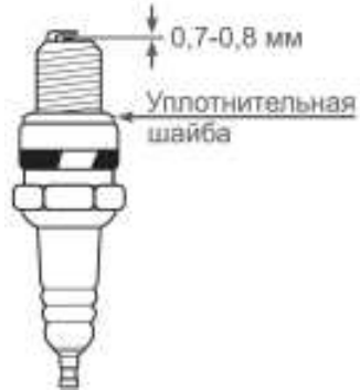
Рис. 1 За ор ме ду э электродами свечи а игия
