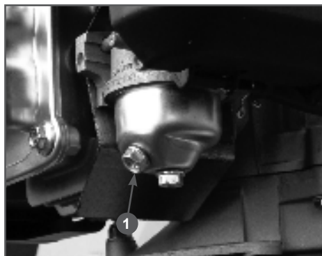
Рис. 18 Слив топлива из карбюратора
