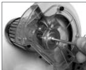
Рис. 3 Снятие крышки защитного кожуха
