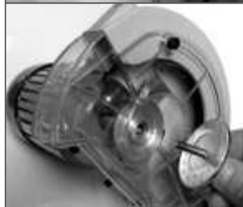
Рис. 4 Снятие прижимной шайбы заточного диска
