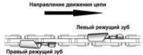
Рис. 12 Определение типа режущего зуба
