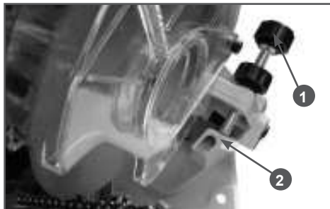
Рис. 17 Винт регулировки глубины ато ки 1. Винт регулировки глубины заточки 2. Ограничитель
