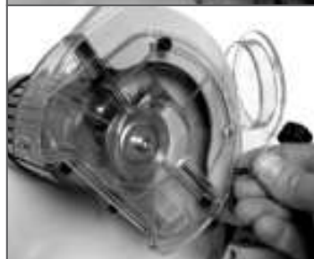
Рис. 3 Снятие крышки защитного кожуха
