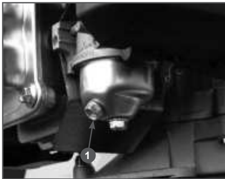
Рис. 19 Слив топлива из карбюратора
