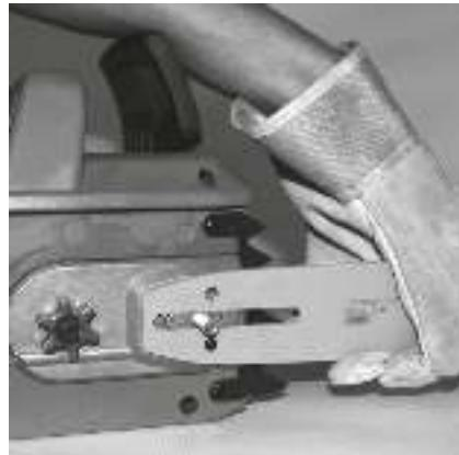
Время от времени переворачивайте полотно шины. Это позволит равномерно распределять износ полотна.
