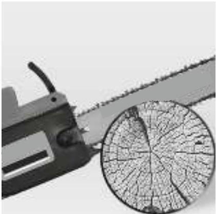
Не стоит прилагать усилия при распиловке древесины, собственный вес пилы позволяет вести процесс распиловки. Если цепь зажало, остановите двигатель, приподнимите или измените положение бревна. Не стоит дергать инструментом для освобождения цепи.
