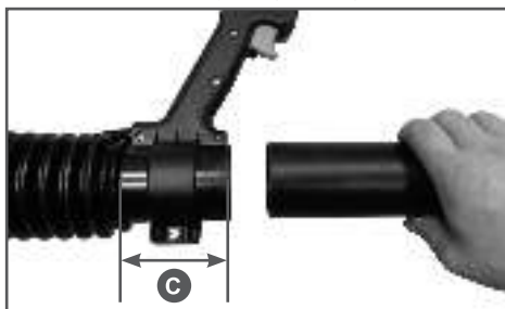
Рис. 4 Установка трубы напорной «А» «С» - Глубина установки трубы напорной «А»
