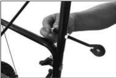
Рис. 13 Монтаж верхней части рычага поворота желоба
