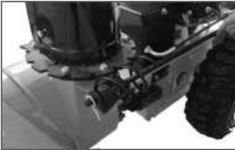
Рис. 1 Установка нижней части рычага поворота желоба
