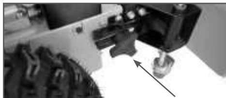
Рис. Отсоединение щетки от корпуса машины
