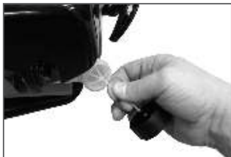
Рис. 14 Снятие крышки топливного бака
