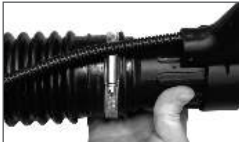
Рис. 5 Установка трубы напорной «А»
