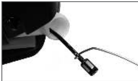
Рис. 15 Извлечение топливного фильтра
