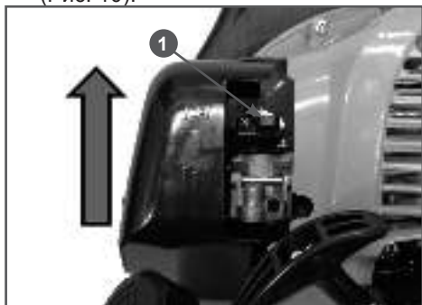
Рис. 10 Воздушная заслонка карбюратора закрыта
