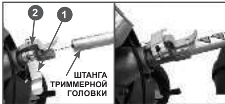
Рис. 3 Установка триммерной головки
