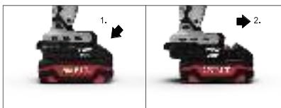
Чтобы извлечь аккумуляторную батарею (5), нажмите на кнопку разблокировки (6) и извлеките аккумуляторную батарею из электроинструмента, потянув ее назад. **Не применяйте при этом силы.**
