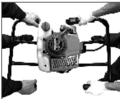
Рис.12 Положение рук при работе вдвоем
