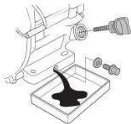
Рис. 17 Замена масла в двигателе
