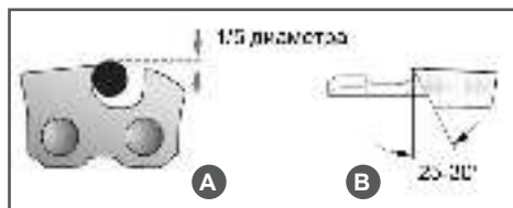
Рис. 19 Положение напильника при заточке режущего зуба
