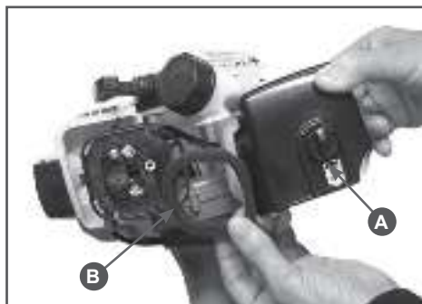
Рис. 13 Обслуживание воздушного фильтра
