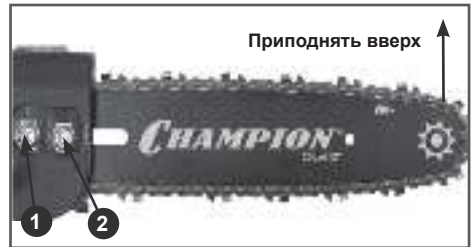
Рис. 6 Установка положения шины
