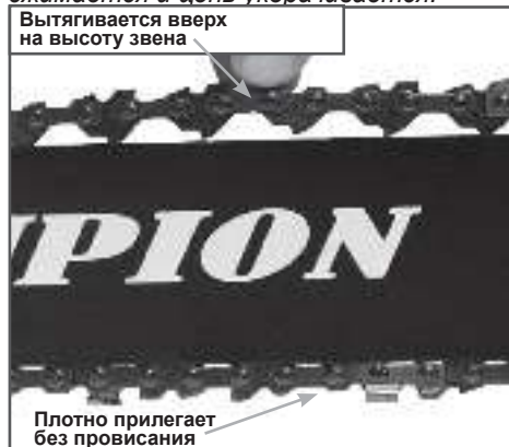
Рис. 7 Регулировка натяжения цепи
