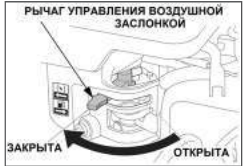
Рис. 14 Рычаг управления воздушной заслонкой (вид сверху)
