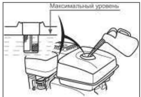
Рис. 12 Максимальный уровень топлива в топливном баке
