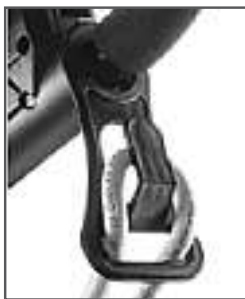
Рис. 10 Фиксация кабеля удлинителя на рабочей рукоятке
