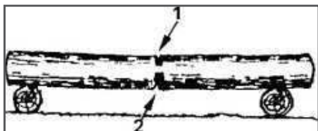
Рис. 13. Пропилы при раскряжевке дерева на двух опорах
