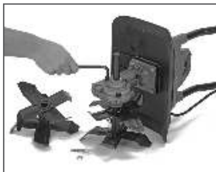
Рис. 7 Проверка смазки в редукторе
