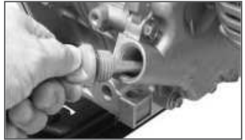
Рис. 5 Проверка уровня масла в картере
