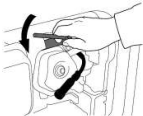
Рис. 22 Обслуживание свечи зажигания
