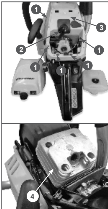
Рис. 23 Очистка охлаждающих ребер цилиндра
