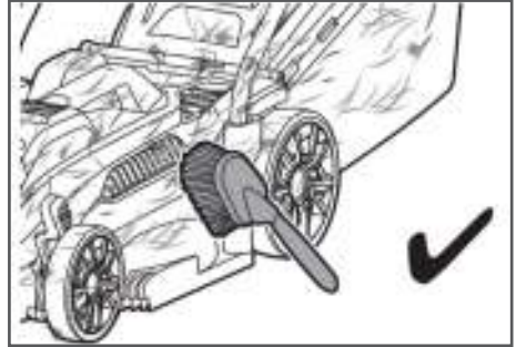
Рис. 14 Обслуживание вентиляционных отверстий охлаждения двигателя
