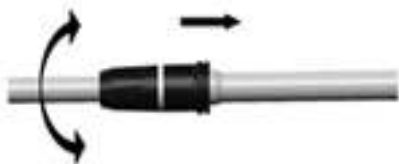
Рис. 5 Установка длины телескопической штанги
