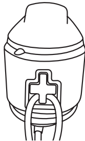
Рис. 11. Крепление кабеля удлинителя
