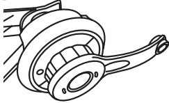
Рис. 14. Откручивание головки при помощи ключа
