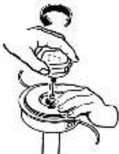
Рис. 19. Закручивание винта крепления триммерной головки
