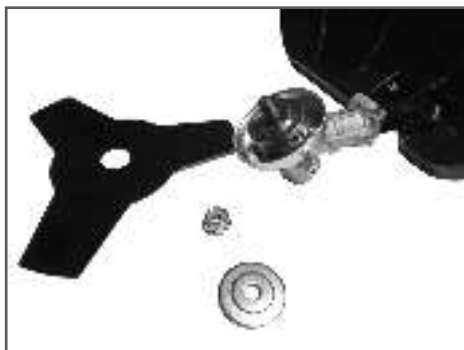
Рис. 8. Установка защитной шайбы
