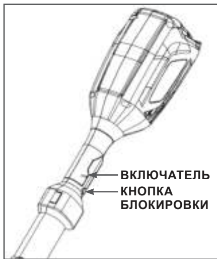
Рис. 9 Расположение органов управления на задней рукоятке
