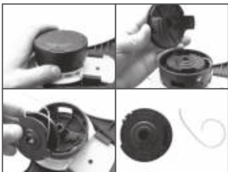
Рис. 13 Извлечение корда из триммерной головки
