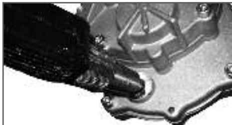
Рис. 15 Добавление смазки в корпус редуктора
