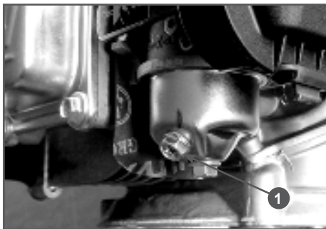
Рис. 11 Слив топлива из карбюратора
