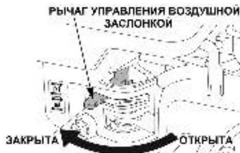
Рис. 19 Рычаг управления воздушной заслонкой
