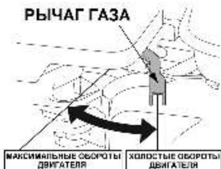
Рис. 21 Положения рычага газа
