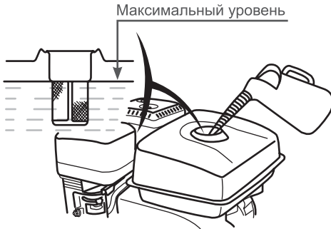
Рис. 18 Максимальный уровень топлива в топливном баке
