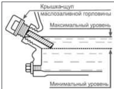
Рис. 18 Проверка уровня масла в картере
