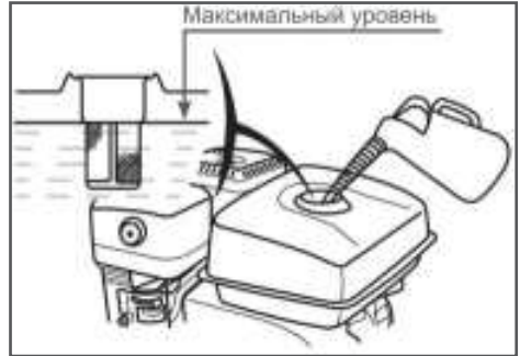
Рис. 19 Максимальный уровень топлива в топливном баке
