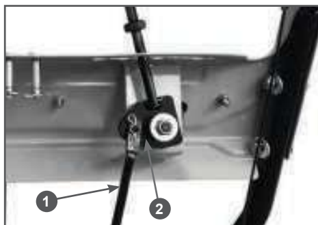
Рис. 6 Подключение тяги к рычагу переключения передач
