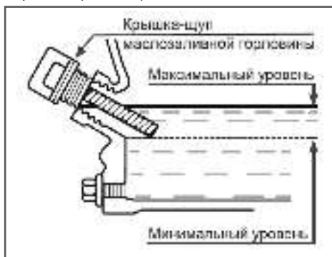
Рис. 11 Проверка уровня масла в картере
