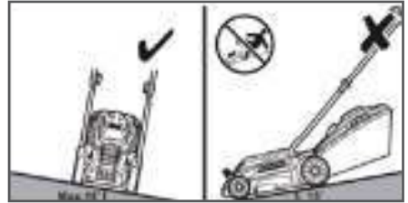
Рис. 13 Положение газонокосилки при кошении на склонах
