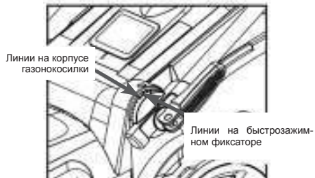
Рис. 2 Установка нижней части рабочей рукоятки
