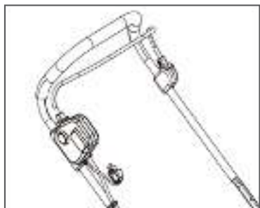
Рис. 11 Положение рычага выключателя и ключа безопасности на выключенном устройстве
