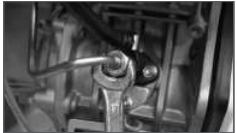
Рис. 12 Удаление воздуха из топливного насоса
