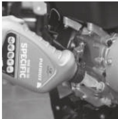
Открутите болт сливного отверстия и крышку маслозаливной горловины. Слейте отработанное масло. Производите замену моторного масла первый раз после 5 моточасов работы. Периодичность замены моторного масла во время эксплуатации мотокультиватора - каждые 50 моточасов работы или 1 раз в сезон.
