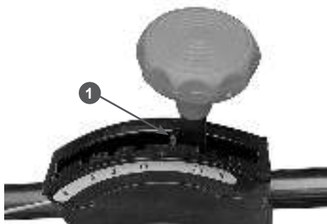
Рис. 11 Установка рычага в нейтральное положение
