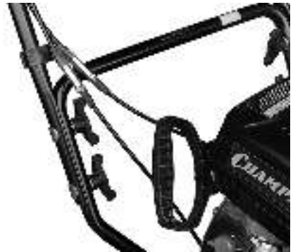
Рис. 4 Установка рабочих рукояток
