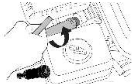
Рис. 33 Обслуживание свечи зажигания
