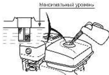
Рис. 20 Максимальный уровень топлива в топливном баке
