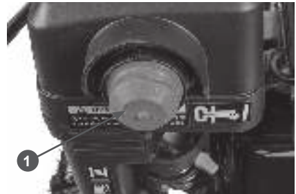
Рис. 26 Расположение ручного топливного насоса
