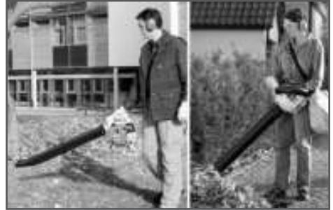
Рис. 9 Положение оператора при работе воздуходувным устройством
