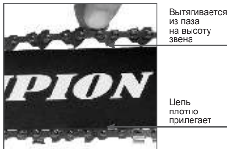
Рис. 5 Регулировка натяжения цепи
