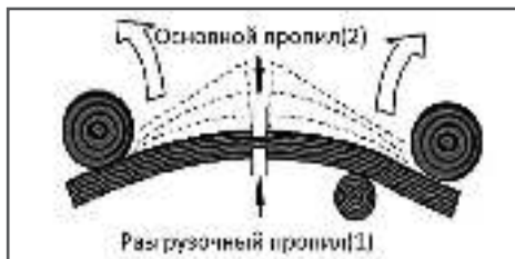
Рис. 18 Распиливание дерева, когда оба конца дерева зажаты и находятся под напряжением
