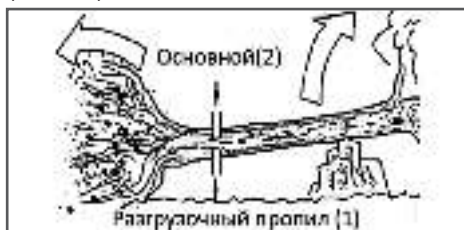
Рис. 17 Распиливание дерева, когда толстый ствол с комлевой частью находится под напряжением
