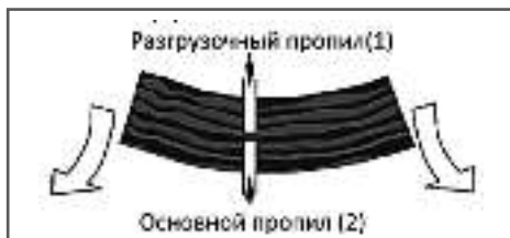
Рис. 16 Распиливание дерева, когда его нижняя часть находится под напряжением Сначала всегда отпиливается комлевая часть. Делается разгрузочный пропил 1 снизу, затем основной пропил 2 сверху (Рис. 17).
