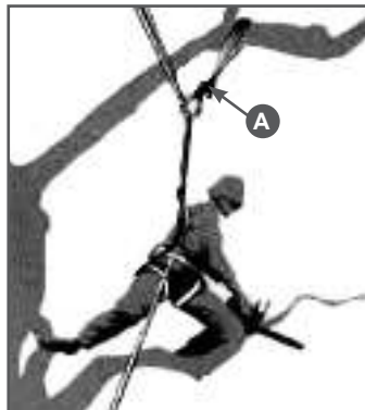
Рис. 21 Положение оператора при горизонтальном пилении
