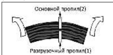
Рис. 15 Распиливание дерева, когда его верхняя часть находится под напряжением
