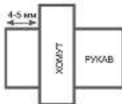
Рис. 6 Расположение хомута на рукаве
