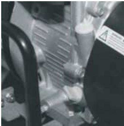
Двигатель необходимо очищать от грязи каждый раз после окончания работы с культиватором. Грязный двигатель и загрязненные ребра цилиндра двигателя могут стать причиной его перегрева и поломки.
