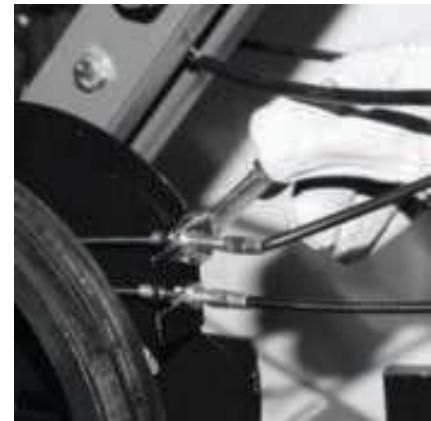
Со временем тросы привода могут растянуться. Для их регулировки необходимо расконтрить гайки и добиться оптимального натяжения тросов. Идеальным натяжением считается, когда надежное вращение ремней обеспечивает заданный режим работы. Одновременно ремни вращаться не должны.
