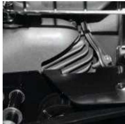
Регулярно очищайте от загрязнений (почва, остатки травы, масло) ребра цилиндра кисточкой и/или баллоном сжатым воздухом.
