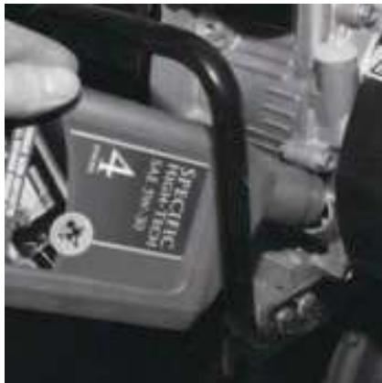
Закрутите болт сливного отверстия. Залейте новое масло до уровня, указанного на щупе. При эксплуатации культиватора при сильной нагрузке или при повышенной температуре окружающего воздуха масло следует заменять каждые 25 моточасов. Помните, что культиватор поставляется без моторного масла в двигателе.
