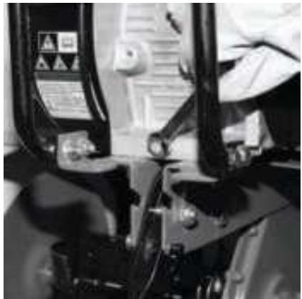
Открутите болт сливного отверстия и крышку маслозаливной горловины. Слейте отработанное масло. Производите замену моторного масла первый раз после 5 моточасов работы. Периодичность замены моторного масла во время эксплуатации мотокультиватора один раз каждые 50 моточасов работы.
