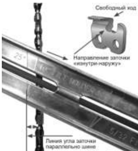
Рис. 15 Определение угла заточки
